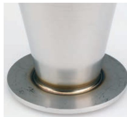
Rura stożkowa przyspawana metodą TIG do płyty. Zwróć uwagę na cienkość spoiny
