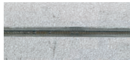
Ocynkowana stal miękka – Topienie plazmowe, grubość 0,5 mm
