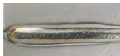
Stal nierdzewna – Spawanie z oczkiem, grubość 6 mm
