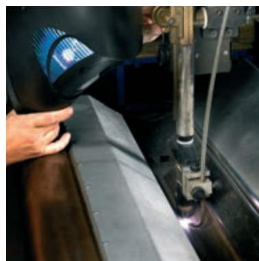
Spawanie plazmowe stali nierdzewnej za pomocą automatu do długich zgrzein liniowych
